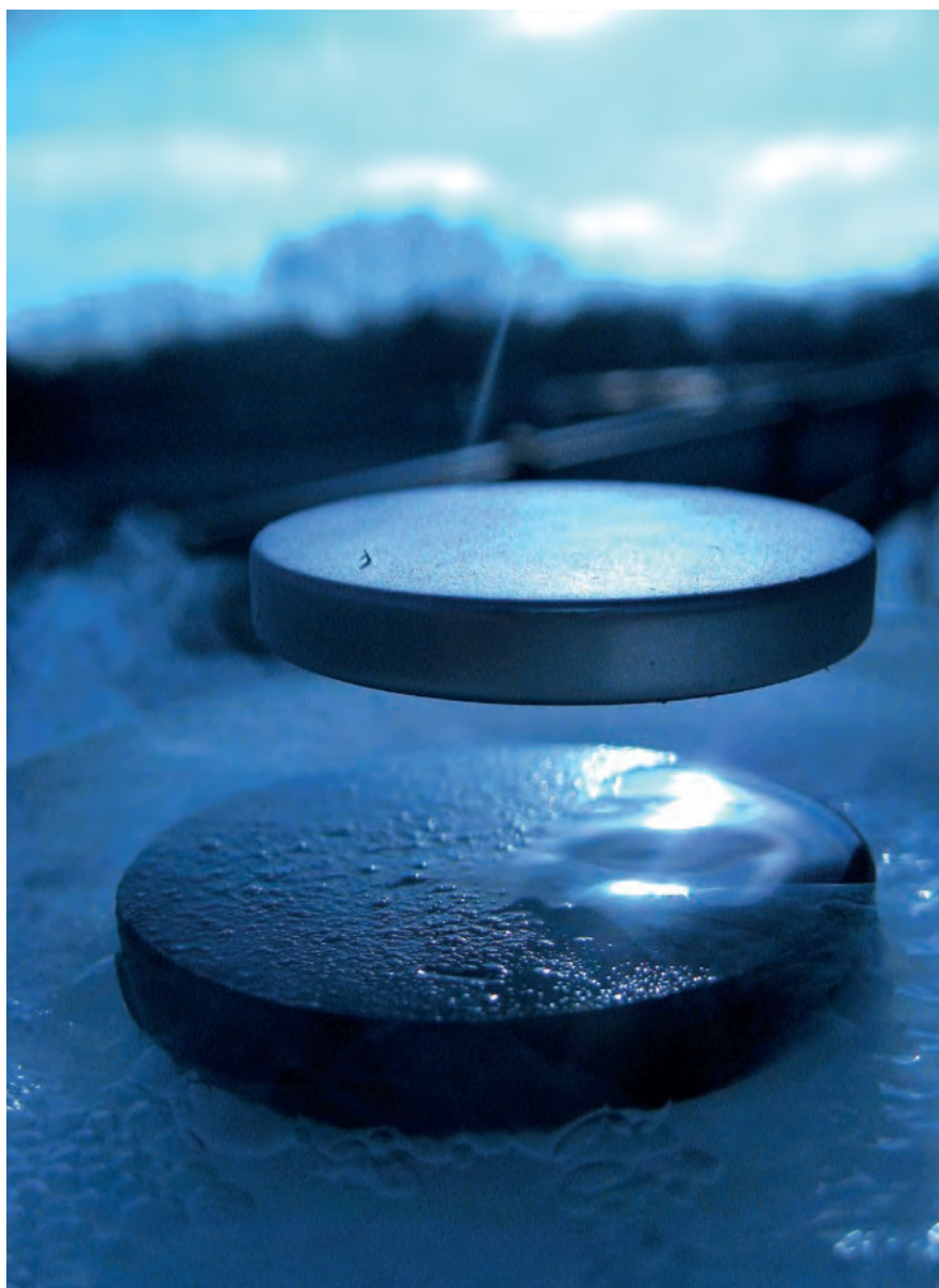
Püsिमagnet leviteerib –196 Celsiuse kraadini jahutatud kupraadist ( \text{YBa}_2\text{Cu}_3\text{O}_7 ) ülijuhi kohal
