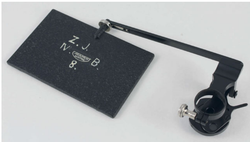
Joonistusaparaat mikroskoobi juurde (firma Reichert, Austria, 20. sajand)
