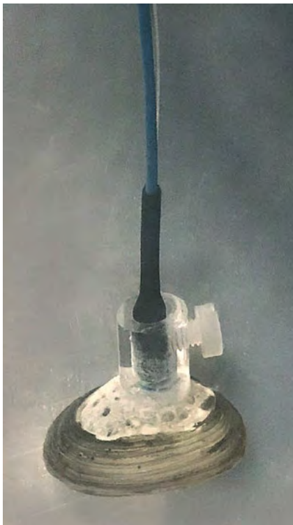
Projekti HAZLESS raames mõõdetakse Balti lamekarbi ( Limecola balthica ) südametegevuse aktiivsust
