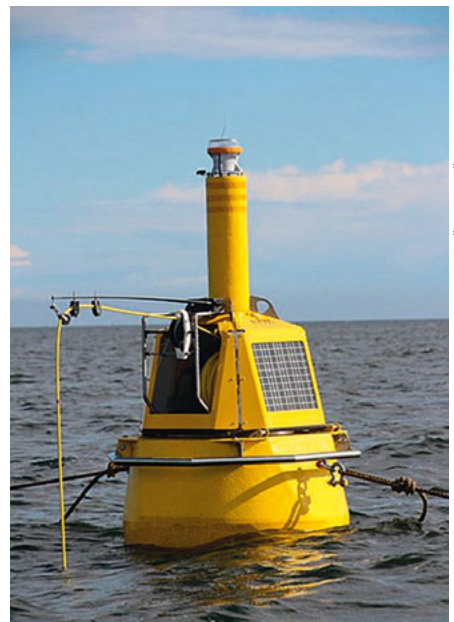
Profileerivad poijaamad, mille otstarve on registreerida keskkonnaparameetrite vertikaalseid jaotisi ja edastada andmeid reaalajas (parempoolse seadme on Eestis arendanud firma Flydog)
