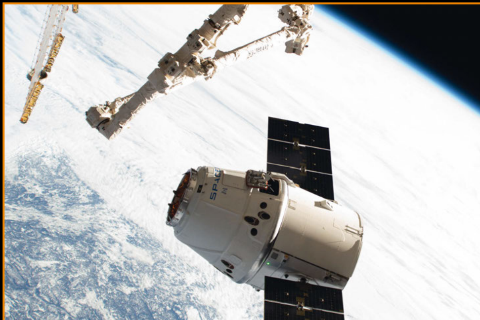
Robotkäpp on haaramas Dragonist, et aidata sel pökkuda kosmosejaamaga
