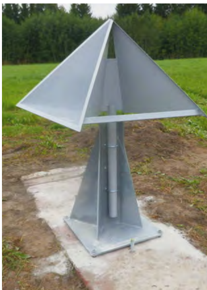
Elektroonilise hoiatussüsteemi Sille arendamisel kasutatud Raplamaa katsepolügooni peegeldaja, mis peegeldab tagasi satelliidilt tulnud mikrolaine impulsi
