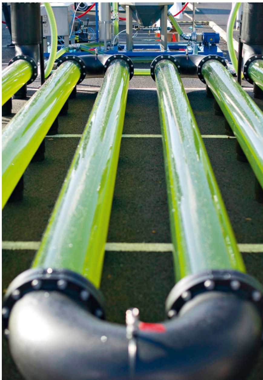
Etanooli ja biodiisli toomiseks kasutatavate vetikate kasvatamiseks mõeldud torusüsteem
