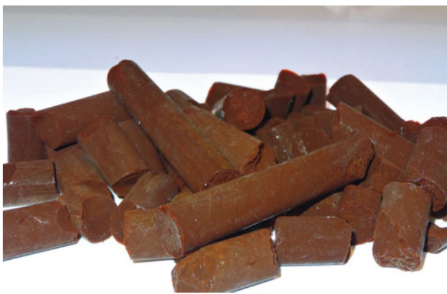
Kohtla-Järve õlitehastest pärit põlevkivifenoolidest saadud unikaalne orgaaniline aerogel
