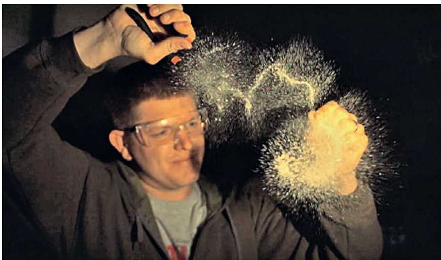
Kaader portaali Youtube õppevideoseeria „Smarter Every Day“ klipist: kui saatejuht Destin Sandlin naksab näpitsatega klaasstilga saba katki, plahvatab see hetkega pisikesteks kildudeks
