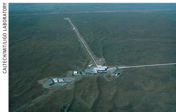
Üks LIGO interferomeetritest Washingtoni osariigis Hanfordis. Fotol on täielikult nähtav üks kahest 4 km pikkusest interferomeetri õlast. Teine detektor paikneb 3002 km kaugusel Louisiana osariigis Livingston'is
