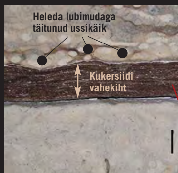
Kukersiidi vahekiht Kerguta puursüdamikus sügavusel 106,95–106,97 meetrit.
