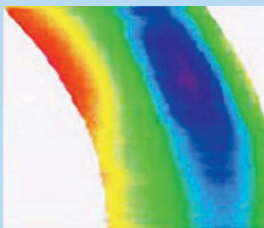
Automaatpolariskoobiga mõõdetud jääkpingete väli kõrgsurvelambi seinas.
