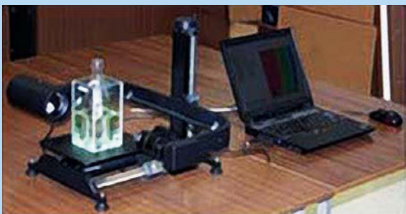
Automaatpolariskoop koos immersioonivanni ja katseobjektiga.
