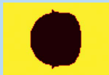
Martensiitse osa kuju pärast vastastikmõju deformatsioonilainega.
