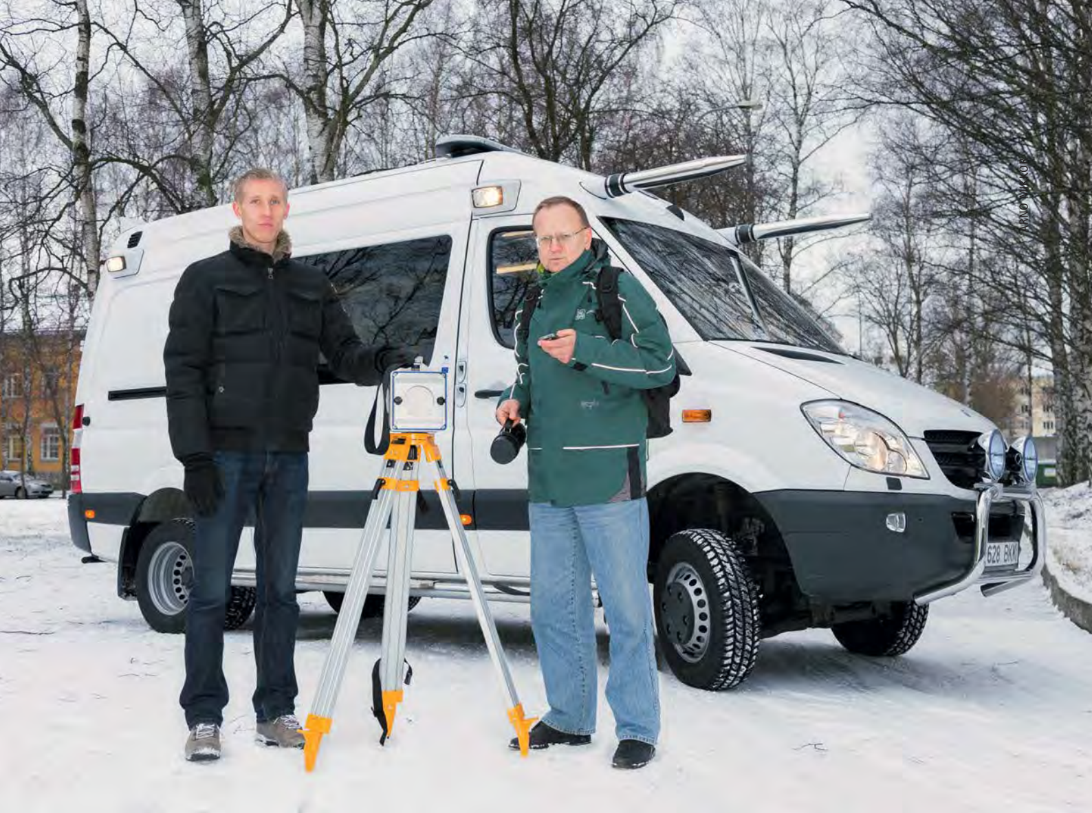
Kiirgusseire spetsialistid Uko Rand (vasakul) ja Alar Polt (paremal) laborbussi ees. Uko Ranna käe all olev seade „Lilliput” mõõdab õhu radioaktiivsust. Alar Poldil on seljas kott kaasaskantava kiirgusseiresüsteemiga, millelt tuleb info on jälgitav mobiiltelefoni ekraanilt.
