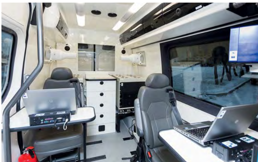
Sisevaade: taga seintel paistvad valged „torud“ on kiirguse detektorid, nende all sahtlimooduliga eraldatud autonoomne server ja elektritoitesüsteem.
