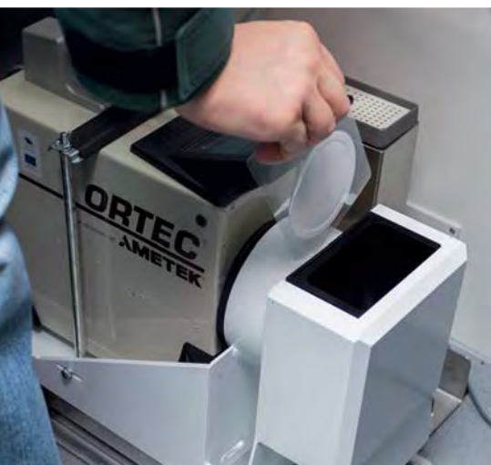
Labori üks tähtsaim „sensor“ – kaasaskantav gammaspektromeeter. Proovid tuleb analüüsimiseks panna selle tundliku otsa ette (pildil näha olevasse musta kandilisse avausse).
